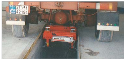
P300 手动泵和10吨油缸用于汽车顶升
