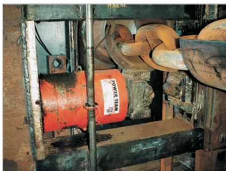
PE4004S泵和RD3006油缸用于特殊的压床，修复损坏的链条连接。
